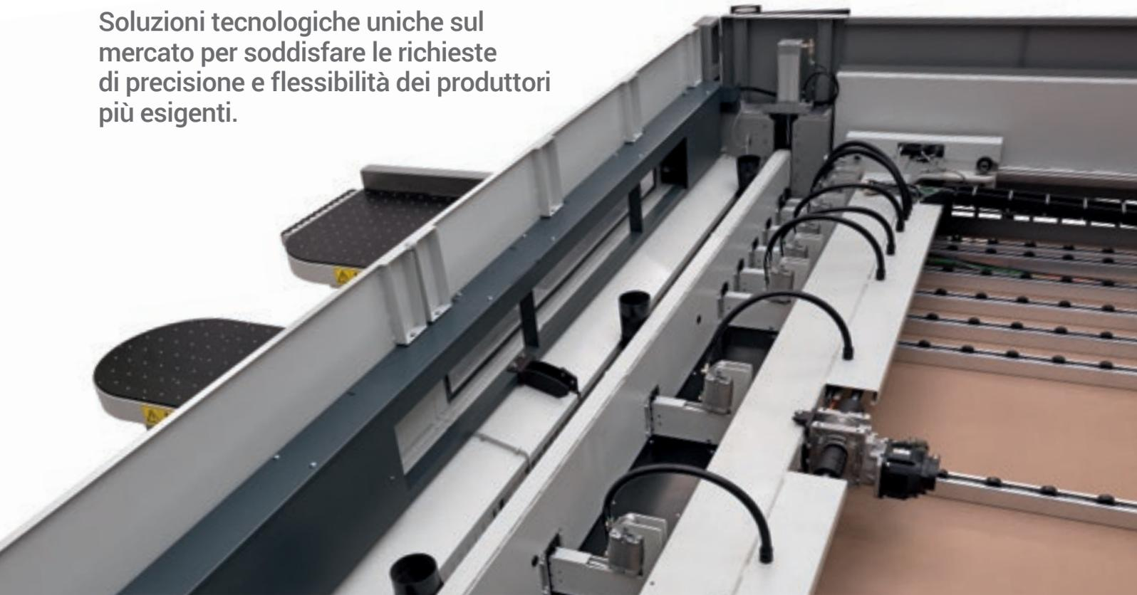
Il pressore ha una struttura a singolo elemento che consente una pressione omogenea e controllata sul pacco di pannelli da tagliare. L'apertura è ottimizzata automaticamente in funzione dello spessore del pacco di pannelli per ottenere la migliore qualità di taglio e ridurre il tempo ciclo.
